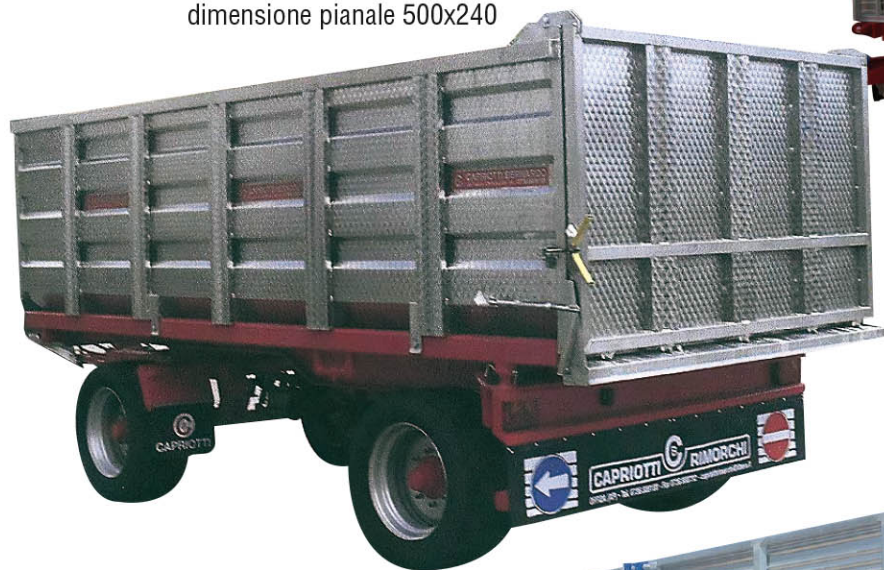
BCF/140S con vasca inox bullonata smontabile omologata dimensione pianale 500x240
